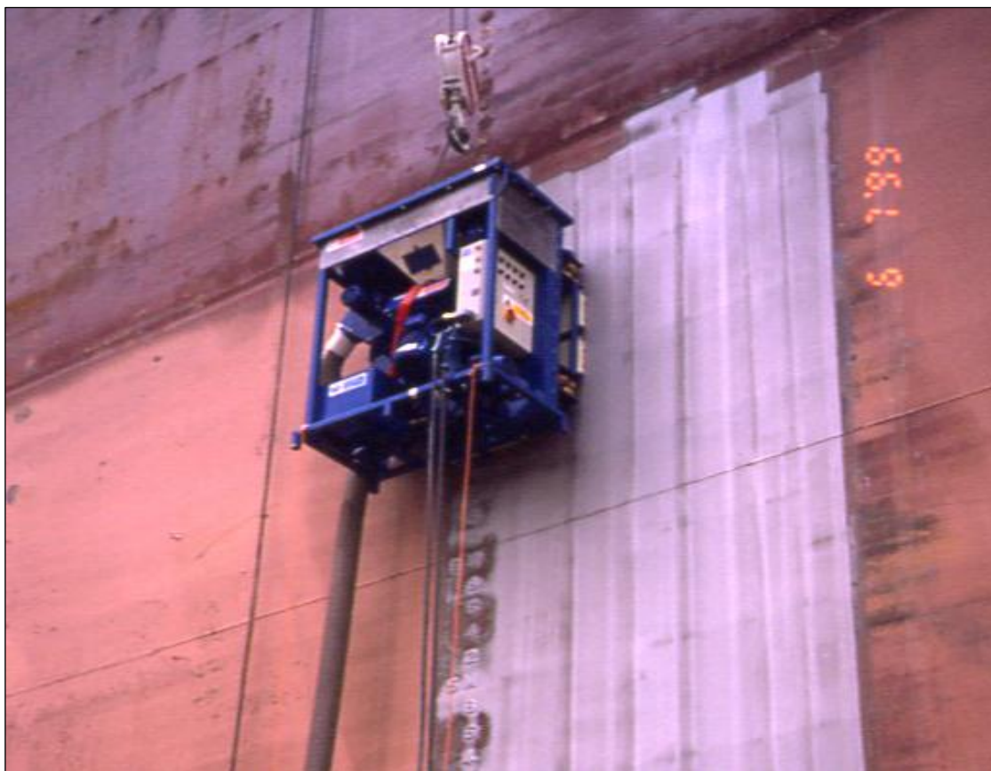
Figura 65. Jateamento do casco por hydroblasting com utilização de “Robot” – (Fonte: McQuilling Partners, Inc.).
