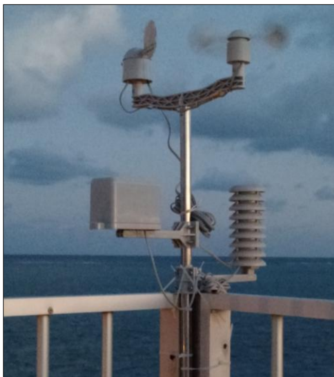
Figura 3. Estação meteorológica automática utilizada para realizar as medições em campo. (Fonte. BELOV, 2015)
