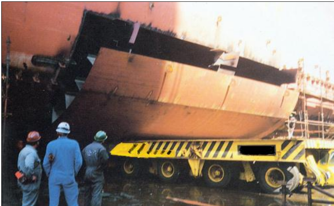
Figura 49. Montagem de um bloco de fundo em doca – (Fonte. McQuilling Partners, Inc.).
