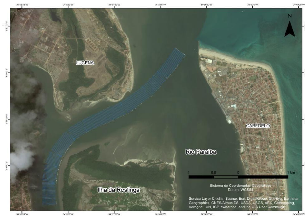
Figura 123. Mapa com levantamento do canal a ser dragado. Fonte: Companhia Docas de Cabedelo/PB.
