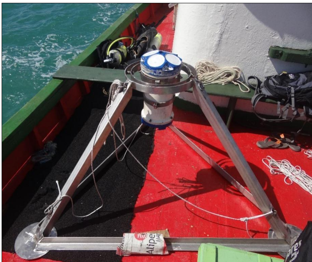
Figura 15. ADCP 600 KHz Workhorse Sentinel Teledyne RDI, acoplado a uma estrutura de aço inox com eixo cardã. O local de fundeio está ilustrado na Figura 14 . (Fonte. BELOV, 2015)
