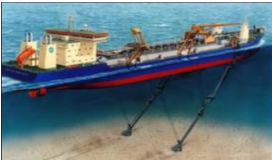
Figura 27. Esquema de Draga Tipo Hopper – (Fonte. McQuilling Partners, Inc.).
