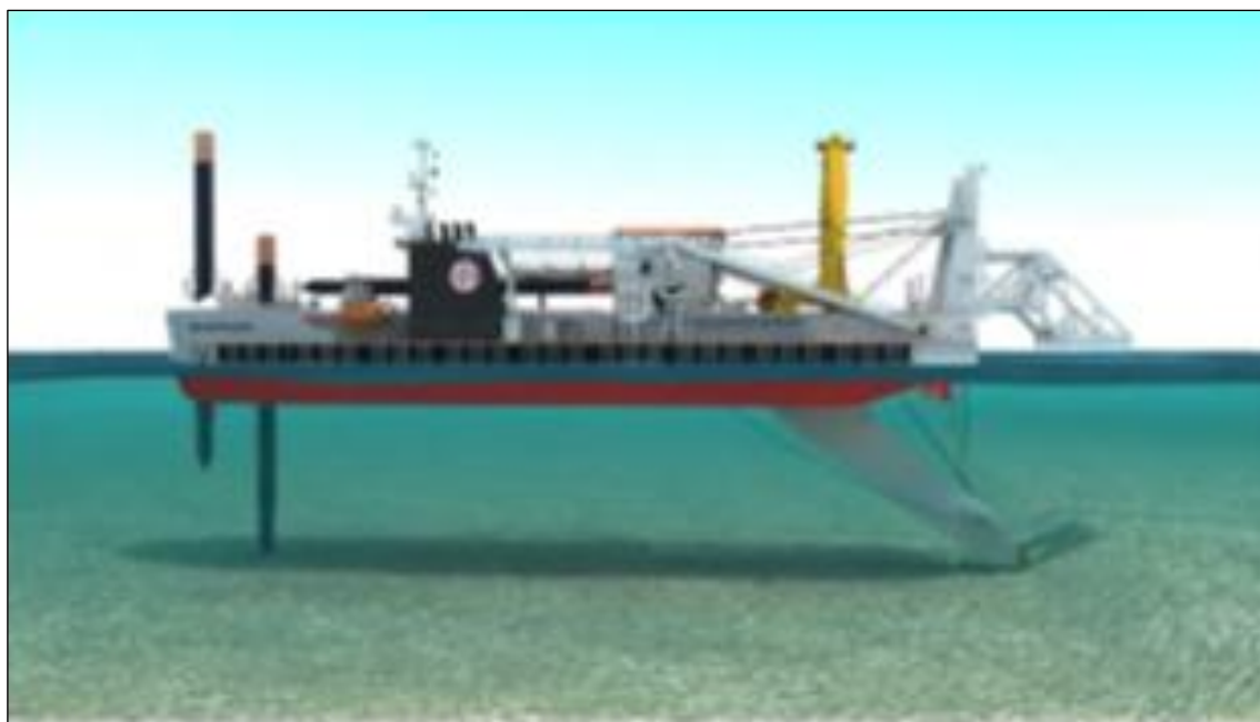
Figura 26. Esquema de draga tipo sucção e recalque – (Fonte. McQuilling Partners, Inc.).
