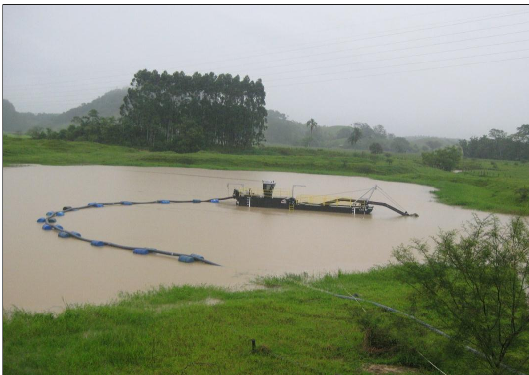
Figura 137. Linha de recalque de material fragmentado pela draga com cabeça cortadora.
