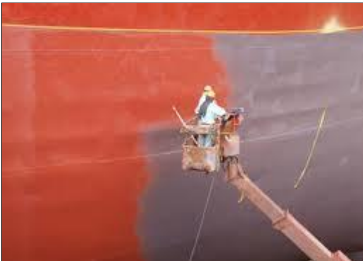
Figura 47. Pintura do costado do navio – (Fonte. McQuilling Partners, Inc.).
